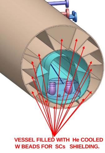
IDS120j: yz CROSS SECTION WITH DETAILS OF THE BP#2 SEGMENTATION IN CRYO#2 REGION
