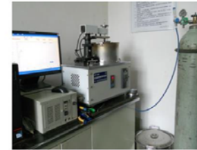
实验条件: 速度 0.2m/s; 载荷 5N; 温度: RT, 300-1000°C
